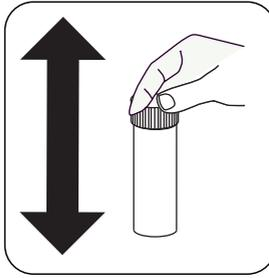
Fermez le tube à essai à l'aide du couvercle et mélangez le contenu en agitant fortement pendant 1 minute.
