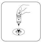
Placez la cuvette Ammoniac dans la chambre de mesure. Attention à la positionner correctement.
