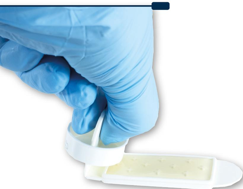
Lames flexibles & profil de gélose surélevé permettent à l'utilisateur de tester à la fois les surfaces & les liquids.
