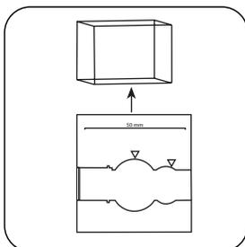
Prelevare la **cuvetta** dal vano di misurazione.
