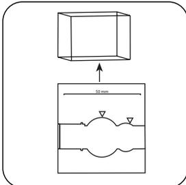
Prelevare la **cuvetta** dal vano di misurazione.
