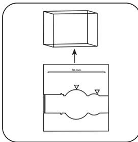
Prelevare la **cuvetta** dal vano di misurazione.
