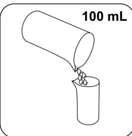
Rellenar la muestra con **agua desionizada** hasta **100 mL**.
