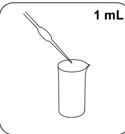
Adicionar **1 mL ácido sulfúrico concentrado**.
