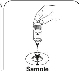
Die **Probenküvette** in den Messschacht stellen.
