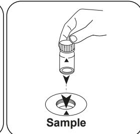
Die **Probenküvette** in den Messschacht stellen.
