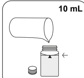
24-mm-Küvette mit **10 mL** Küvette(n) verschließen.
