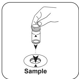
Die Probenküvette in den Messschacht stellen.
