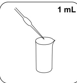
Adicionar **1 mL ácido sulfúrico concentrado**.
