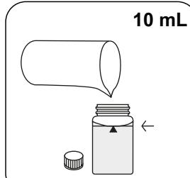
24-mm-Küvette mit **10 mL** Probe füllen.
