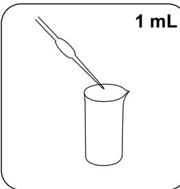
Añadir **1 mL de ácido sulfúrico concentrado**.
