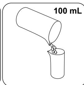
Rellenar la muestra con **agua desionizada** hasta **100 mL**.
