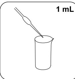
Añadir **1 mL de ácido sulfúrico concentrado**.
