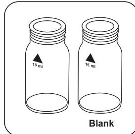
Preparare due cuvette pulite da 24 mm.
