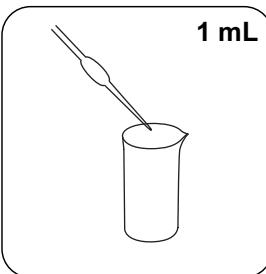
Añadir **1 mL de ácido sulfúrico concentrado**.
