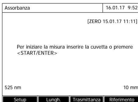
Se non è stata ancora eseguita una regolazione zero, il fotometro invita l'utilizzatore a eseguirla.
