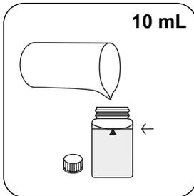
**10 mL Nitrite VHR L Lösung** in die Probenküvette geben.
