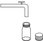
Küvette entnehmen, die Probe verwerfen und mehrmals mit filtriertem Wasser ausspülen. Die Küvette nach dem Ausspülen mit dem filtrierten Wasser befüllen und sofort mit der Kappe verschließen. Die Küvette abwischen und bis zum nächsten Einsatz lagern.
