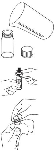
2. Die mit Kalibrierstandard befüllten Flaschen von außen abspülen, um mögliche Anhaftungen von Staub und Schmutz zu entfernen. Anschließend jede Flasche mit einem fusselfreien Tuch trocknen.
