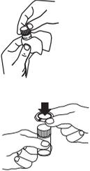
Die Küvette mit destilliertem Wasser oder Wasser, das über einen 0,2 µm-Filter (oder kleineren Porengröße) gefiltert wurden, ausspülen und füllen. Die gefüllte Küvette am Deckel festhalten und mit dem im Lieferumfang enthaltenen Tuch abwischen, um Wassertropfen, Schmutz und Fingerabdrücke zu entfernen. Dann die Küvette mit Silikonöl behandeln, siehe 2.3.2.2.1.
