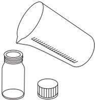
Spülen Sie die Küvette mit ca. 10 mL der Wasserprobe (2/3 des Küvettenvolumens), indem Sie die Küvette mit dem Küvettedeckel verschließen und die Küvette dann mehrere Male schwenken. Schütten Sie die Spüllösung weg und wiederholen Sie den Spülvorgang noch zweimal.
