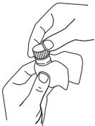
Die Küvette am Deckel festhalten und mit dem im Lieferumfang enthaltenen Tuch abwischen, um Wassertropfen, Schmutz, Staub und Fingerabdrücke zu entfernen. Geringfügige Kratzer können durch Verwendung von Silikonöl minimiert werden. Bei der Anwendung von Silikonöl das Öl vorzugsweise auf ein weiches Tuch auftragen. Mit diesem das Öl gleichmäßig auf der Außenfläche der Küvette verteilen. Überschüssiges Silikonöl von der Küvette abwischen.
