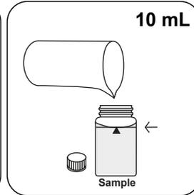
**10 mL Probe** in die Probenküvette geben.
