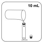
Remplissez une cuvette de Fermez la(les) cuvette(s). 16 mm de 10 mL d'échantillon.
