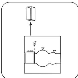
Prelevare la **cuvetta** dal vano di misurazione.
