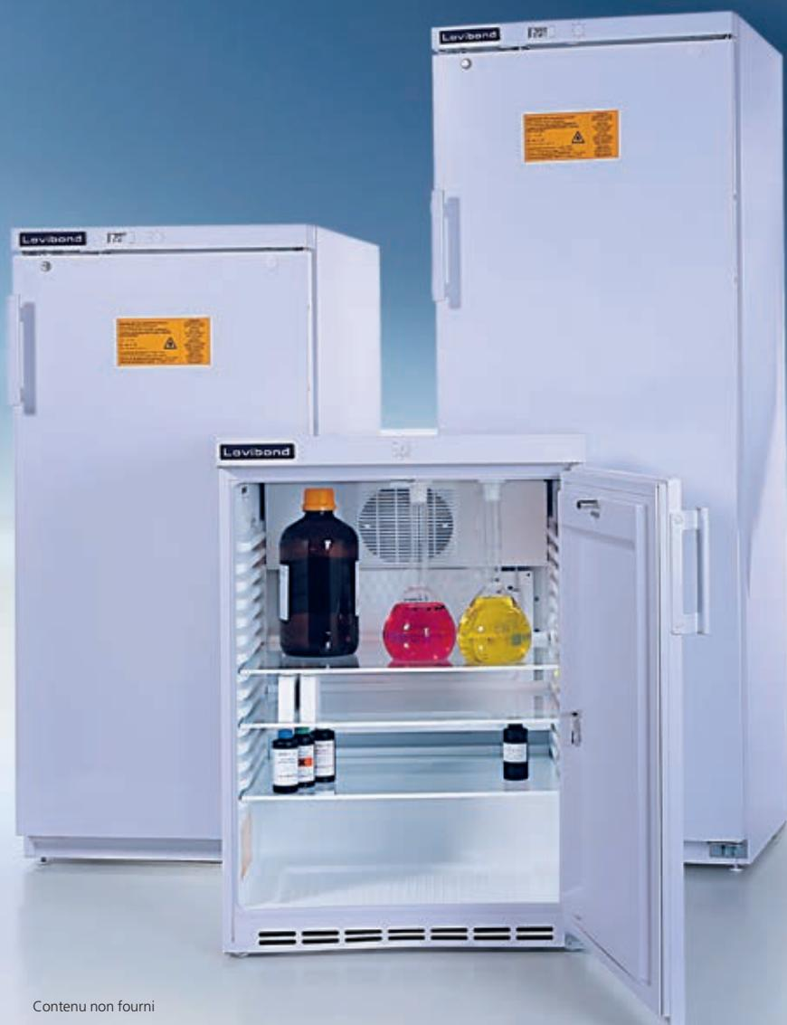
La directive allemande „Travail sécurisé dans les laboratoires BG-I 850-0“ stipule que les espaces intérieurs doivent être protégés contre les explosions là où des atmosphères dangereuses ou explosives peuvent se développer (par exemple, du fait de la présence de liquides inflammables).
