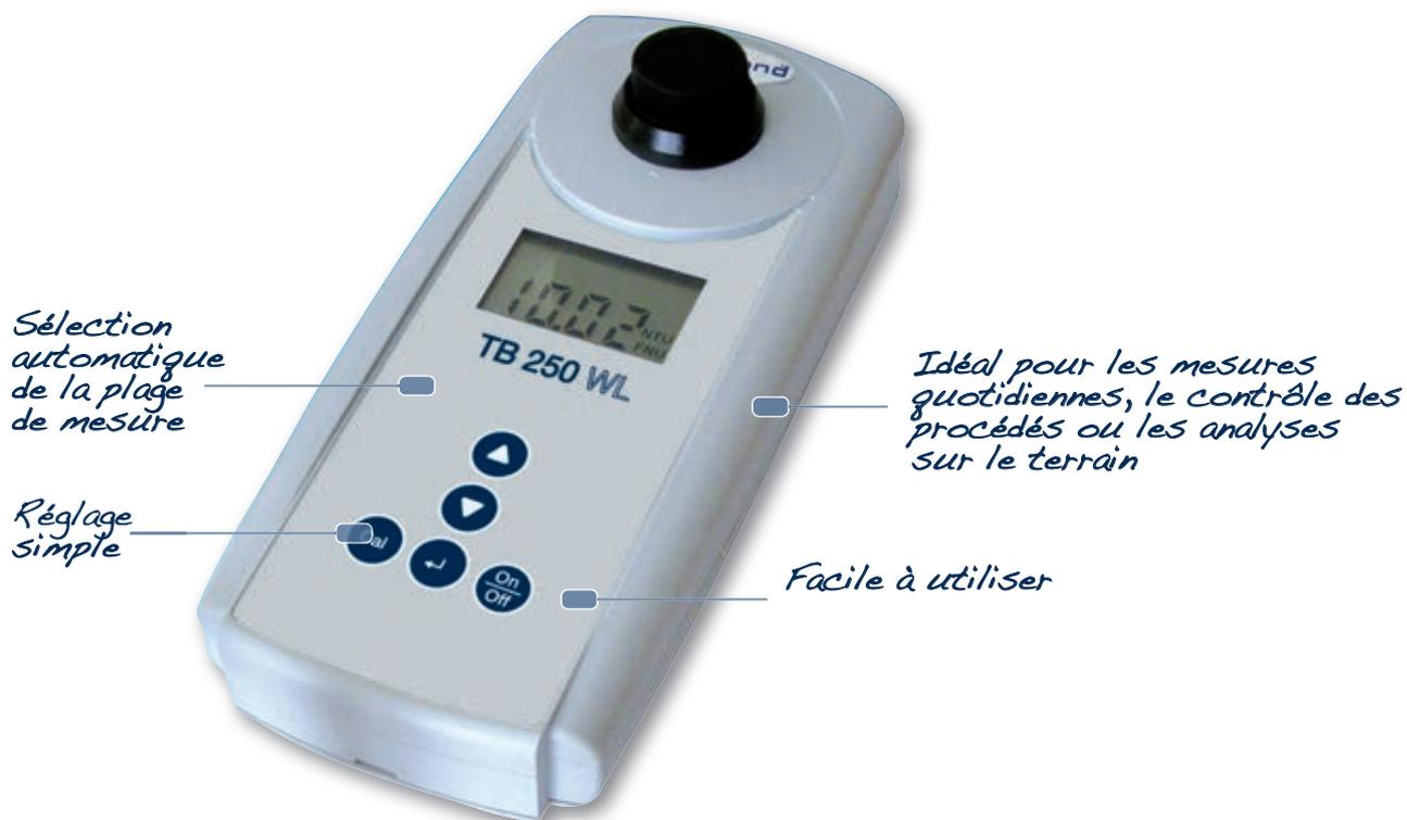
Le TB 250 WL a été développé à la fois pour les utilisations mobiles et la mesure de la turbidité en laboratoire. Il utilise une source de lumière blanche, avec laquelle les mesures sont effectuées selon la méthode de la diffusion lumineuse à 90°.
