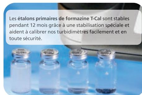
Les étalons primaires de formazine T-Cal sont stables pendant 12 mois grâce à une stabilisation spéciale et aident à calibrer nos turbidimètres facilement et en toute sécurité.
