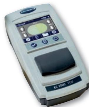
Pour des raisons esthétiques, la coloration de l'eau potable ne doit pas être forte ni même visible. Dans de nombreux pays, la coloration de l'eau potable est donc déterminée par les "True Colour Units" TCU, une valeur numérique des unités Hazen. Pour cette raison, le comparateur EC2000 est également disponible dans une version permettant d'afficher les valeurs en unités TCU.
