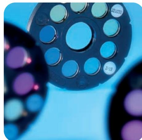
Disque de test avec étalons de verre de couleur stable
