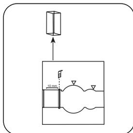
Prelevare la **cuvetta** dal vano di misurazione.
