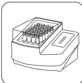
Sottoporre a digestione la/e cuvetta/e nel termoreattore preriscaldato per **30 minuti a 100 °C** .
