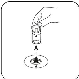
Prelevare la cuvetta dal vano di misurazione.
