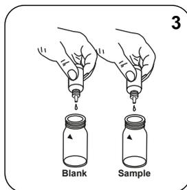
Immettere **3 gocce di soluzione Chloride-51** in ogni cuvetta.
