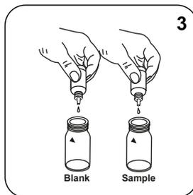
Immettere **3 gocce di soluzione Chloride-52** in ogni cuvetta.
