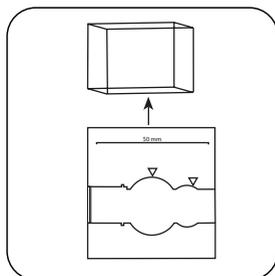
Prelevare la **cuvetta** dal vano di misurazione.
