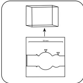
Prelevare la **cuvetta** dal vano di misurazione.
