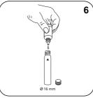
Add 6 drops  $H_2O_2$ -Reagent Solution.
