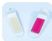
Dipslides für Tests im Kühlwasser
