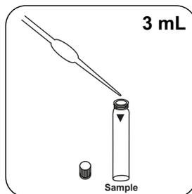
Dans la cuvette réservée à l'échantillon, versez **3 mL d'échantillon préparé**.
