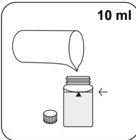
24-mm-Küvette mit **10 ml Probe** füllen.
