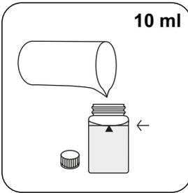
24-mm-Küvette mit **10 ml Probe** füllen.
