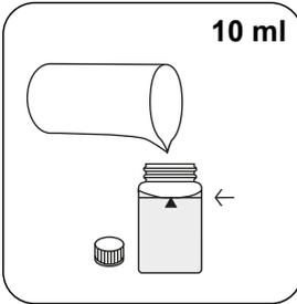
24-mm-Küvette mit **10 ml Probe** füllen.
