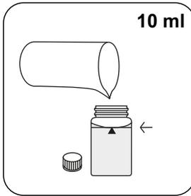
24-mm-Küvette mit **10 ml Probe** füllen.
