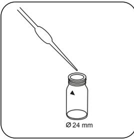
Küvette mit **einigen Tropfen** Probe füllen.
