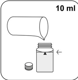
24-mm-Küvette mit **10 ml Probe** füllen.
