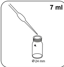
24 mm-Küvette mit 7 ml VE-Wasser füllen.
