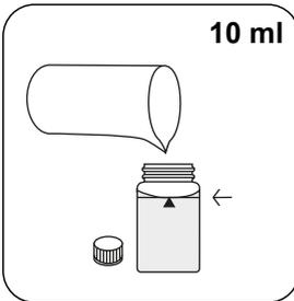
24 mm-Küvette mit **10 ml VE-Wasser** füllen.
