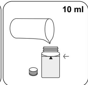
24-mm-Küvette mit **10 ml Probe** füllen.
