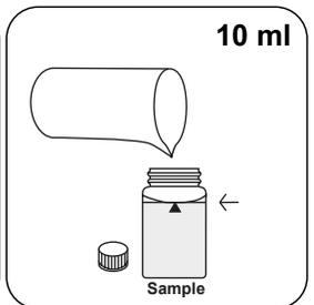
**10 ml der aufgeschlossenen, vorbereiteten Probe** in die Probenküvette füllen.
