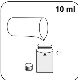
24-mm-Küvette mit **10 ml Probe** füllen.
