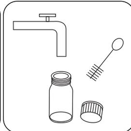
Die Küvette und den Küvettendeckel gründlich reinigen.
