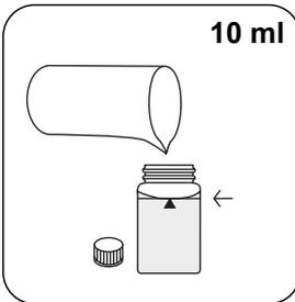
24-mm-Küvette mit **10 ml Probe** füllen.
