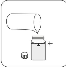
Küvette bis zur **10-ml-Marke** mit **VE-Wasser** auffüllen.
