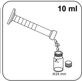
**10 ml Probe** in die Probenküvette geben.
