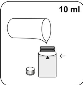
24-mm-Küvette mit **10 ml Probe** füllen.
