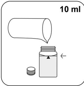
24 mm-Küvette mit **10 ml VE-Wasser** füllen.
