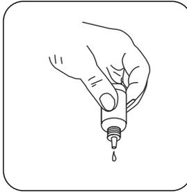
Ajoutez au goutte à goutte **Hardness Calcium Buffer CH2** au même échantillon jusqu'à obtention d'une coloration rosée à rouge. (**Attention : agitez l'échantillon après chaque goutte ajoutée !**)
