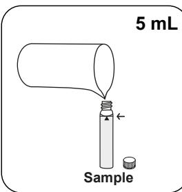
Adicionar **5 mL** de amostra à célula de amostra.
