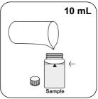
Versez 10 mL d'eau démi- Versez 10 mL d'échantillon dans la cuvette réservée à l'échantillon
