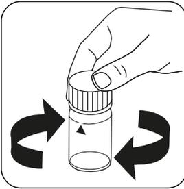
Rotare la cuvetta una volta (**non agitare o capovolgere!**).
