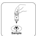
Placez la cuvette réservée Appuyez sur la touche à l'échantillon dans la chambre de mesure. Attention à la positionner correctement.
