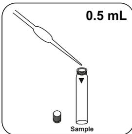
Immettere **0.5 mL del campione preparato e sottoposto a digestione** nella cuvetta del campione.
