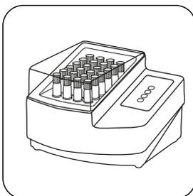
Sottoporre a digestione la/e cuvetta/e nel termoreattore preriscaldato per **60 minuti a 100 °C**.
