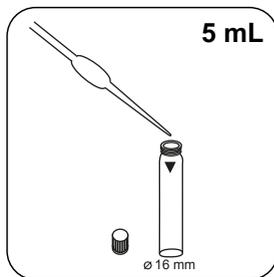
Immettere **5 mL di campione** nella cuvetta di digestione.
