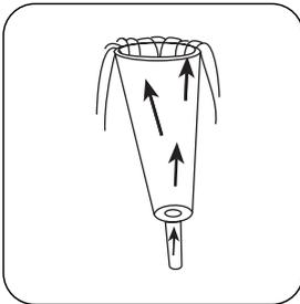
Probenahmegefäß mehrere Minuten von unten nach oben mit Testwasser durchströmen lassen, um Luftblasen zu entfernen.
