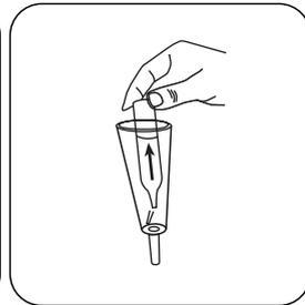
Die volle Ampulle anschließend zügig, mit der Spitze nach unten, aus dem Probenahmegefäß nehmen.
