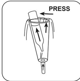
Eine Vacu-vial® Ampulle im Probenahmegefäß platzieren. Die Ampulenspitze durch leichtes Drücken gegen die Gefäßwand abbrechen. Die komplette Füllung der Ampulle abwarten.
