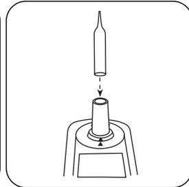
Zero-Ampulle aus dem Messschacht nehmen.
