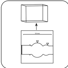
Prelevare la **cuvetta** dal vano di misurazione.
