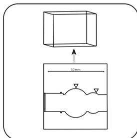
Prelevare la **cuvetta** dal vano di misurazione.
