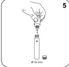
Add **5 drops Reagenz Pb-1K solution** to each vial.
