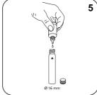
Add **5 drops Reagenz Pb-1K solution** to each vial.
