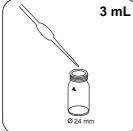
Versez 3 mL d'échantillon dans la cuvette réservée à l'échantillon.
