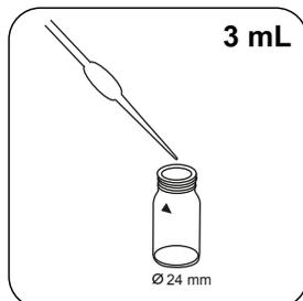
Immettere **3 mL di acqua demineralizzata** nella cuvetta zero.
