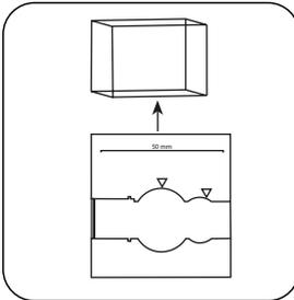
Prelevare la **cuvetta** dal vano di misurazione.
