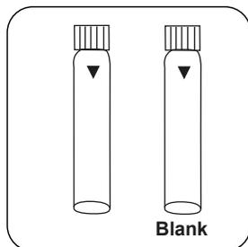
Preparare due **cuvette per reagenti**. Contrassegnare una cuvetta come cuvetta zero.
