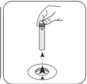
Prelevare la **cuvetta** dal vano di misurazione.
