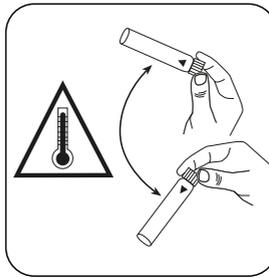
Miscelare il contenuto capovolgendo con cautela. **(ATTENZIONE: la cuvetta diventa molto calda!)**
