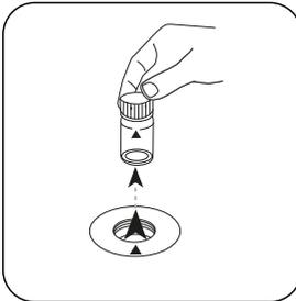
Prelevare la cuvetta dal vano di misurazione.
