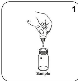
Ajoutez **1 goutte de Ca Mg Hardness SOL 4 (bouteille blanche)** dans la cuvette réservée à l'échantillon.
