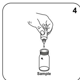
Ajoutez **4 gouttes de Ca Mg Hardness SOL 2 (bouteille bleue)** dans la cuvette réservée à l'échantillon.
