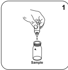
Ajoutez **1 goutte de Ca Mg Hardness SOL 3 (bouteille verte)** dans la cuvette réservée à l'échantillon.
