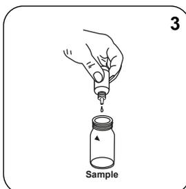
Ajoutez **3 gouttes de Ca Mg Hardness SOL 1 (bouteille rouge)** dans la cuvette réservée à l'échantillon.
