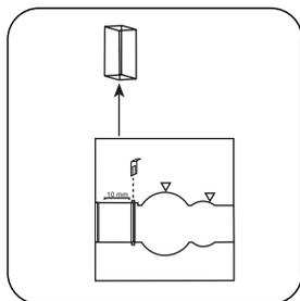
Prelevare la **cuvetta** dal vano di misurazione.
