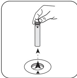
Prelevare la **cuvetta** dal vano di misurazione.
