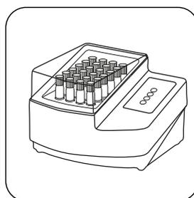
Calentar la cubeta durante **120 minutos a 120 °C** en el termoreactor precalentado **de modo invertido**.
