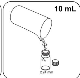
Encher a célula de 24 mm com **10 mL de amostra preparada**.
