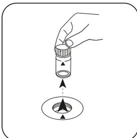
Prelevare la cuvetta dal vano di misurazione.
