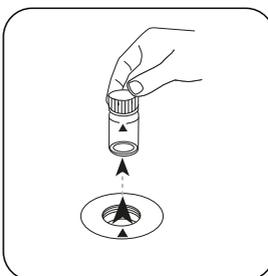
Prelevare la cuvetta dal vano di misurazione.
